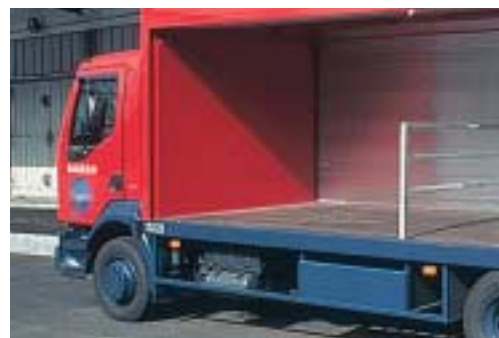
Camion à suspension pneumatique en position basse
