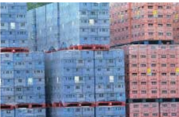
Palettes de casiers empilés sur trois hauteurs au total avec croisement sur la 3 e couche
