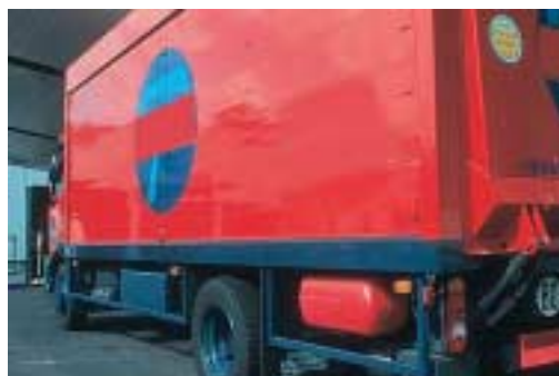
Camion à suspension pneumatique en position de route (haute)
